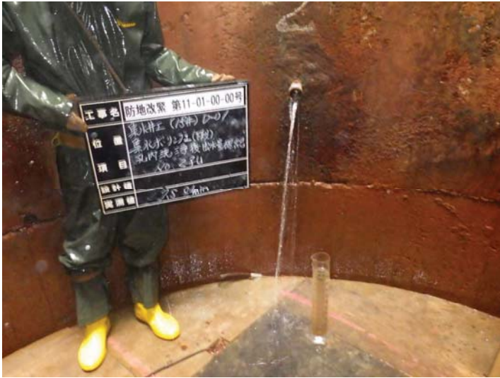
4, 洗浄後 湧水量測定
