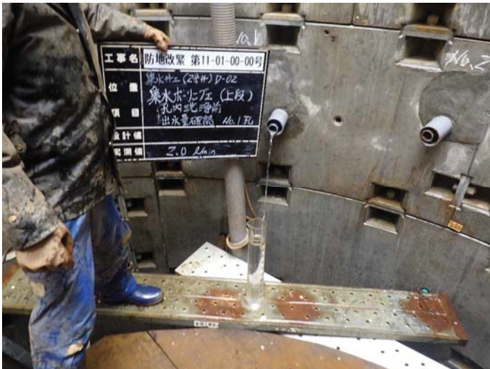
1, 洗浄前 湧水量測定
