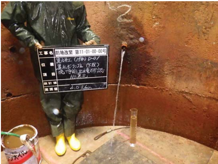
1, 洗浄前 湧水量測定
