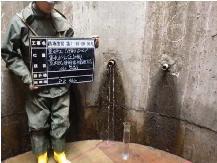
1, 洗浄前 湧水量測定
