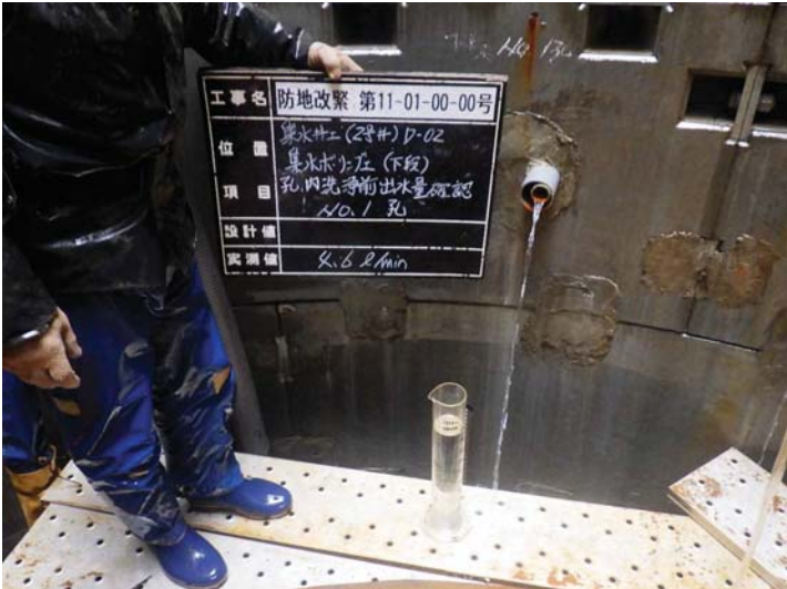
1, 洗浄前 湧水量測定
