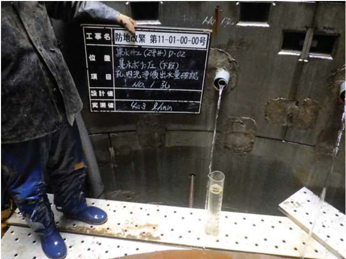
4, 洗浄後 湧水量測定
