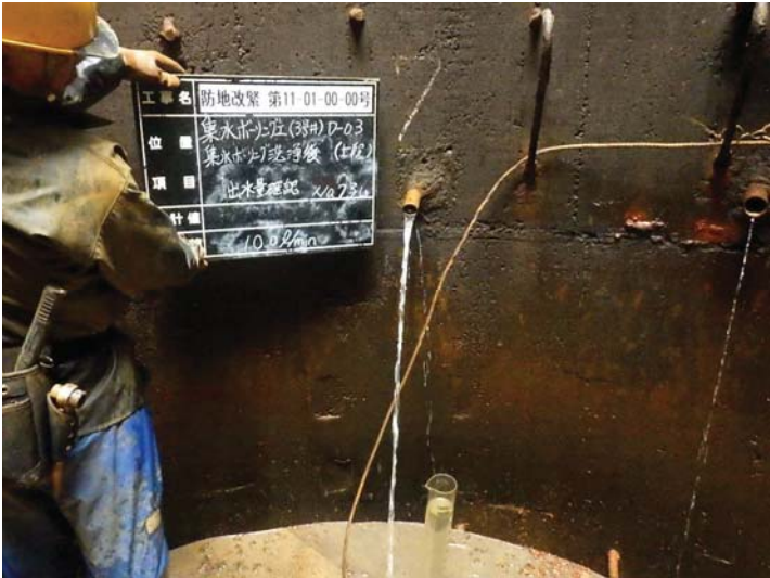
4, 洗浄後 湧水量測定
